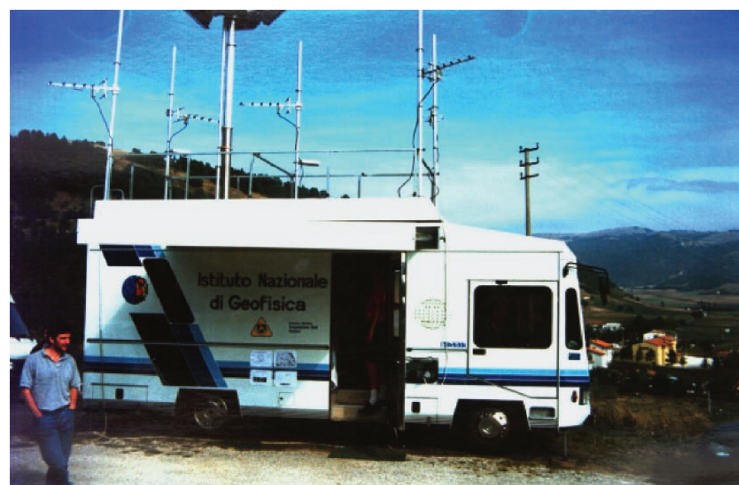
Fig. 2 Centro di acquisizione mobile delle stazioni in telemetria digitale realizzato nel 1990 e utilizzato per la prima volta durante il terremoto di Potenza del 1990. In figura è mostrata la sua applicazione durante la sequenza sismica di Colfiorito (1997).
